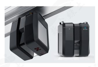
LiCrop 是数字绿土自主研发的作物表型测量系统,集成了以激光雷达为核心、包括多光谱成像仪、高分辨率 RGB 相机、热成像仪等多源传感器,通过标准转接件灵活搭载于室内外平台,可快速采集不同监测尺度下的植物体高精度 3D 点云、真彩色图像以及光谱等信息。结合 LiPlant 植物三维表型参数提取软件,可精准获取目标作物的株高、株幅、叶长、叶片数、叶夹角,群体覆盖度、高度以及分层叶面积密度等参数,为用户提供数据采集、处理分析一站式解决方案,有效服务于作物表型监测及农业管理。
